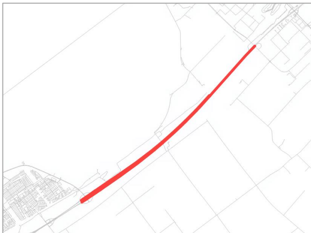
Afbeelding B2.7. Traject op de A6 met verbreding naar 2x4 rijstroken, onderdeel van de infrastructuurmaatregelen in de voorgaande versie van het verkeersmodel.
