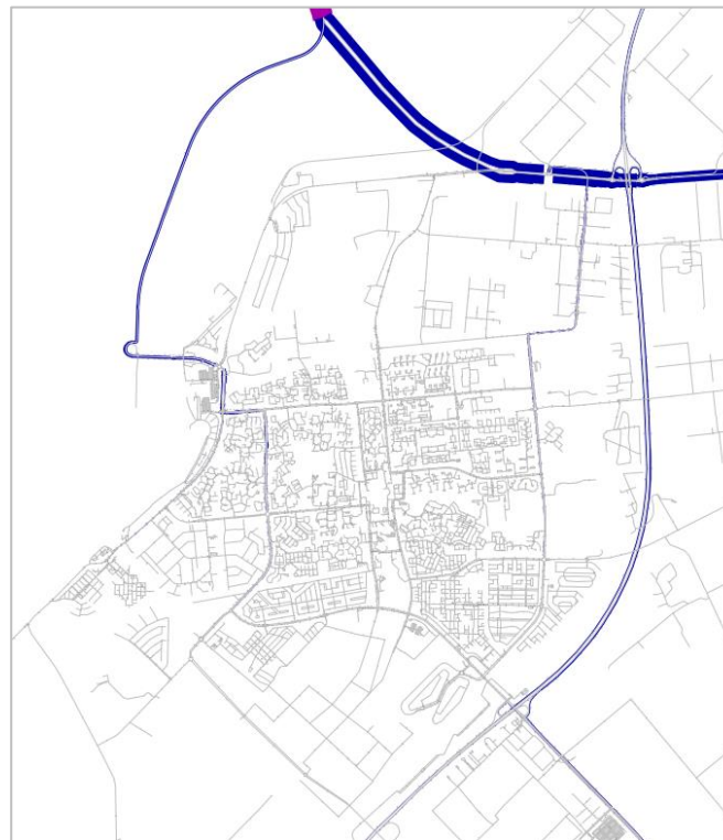
Afbeelding B2.12. Selected link analyse voor motorvoertuigen over het etmaal over de N307, in beide richtingen, voor het scenario met HOV-verbinding en infrastructurele maatregelen met de voorgaande versie van het verkeersmodel.
